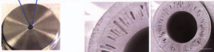
Figuur 12 Methode om meerlaags keramische holle vezels te maken.
